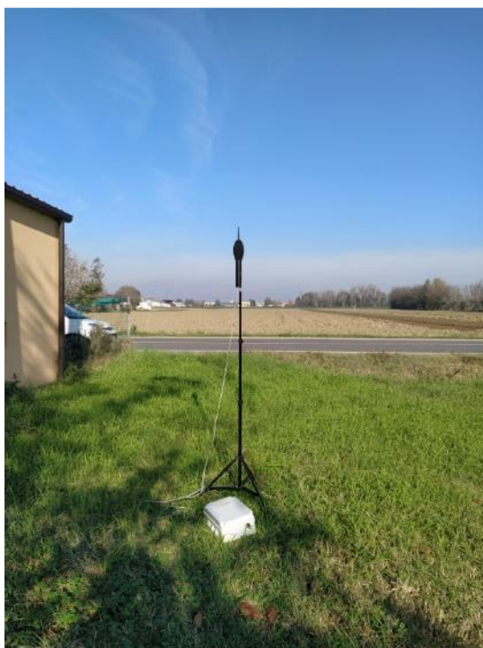
Figura 3 - Esempio posizionamento fonometro RUM_01 e RUM_02
